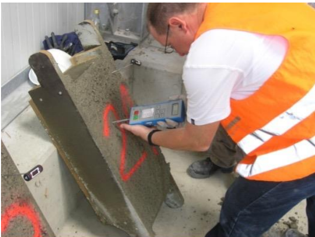
Abb. 2 Messverfahren mit Penetrationsnadel an den Spritzkisten (Bild Schwenk)
