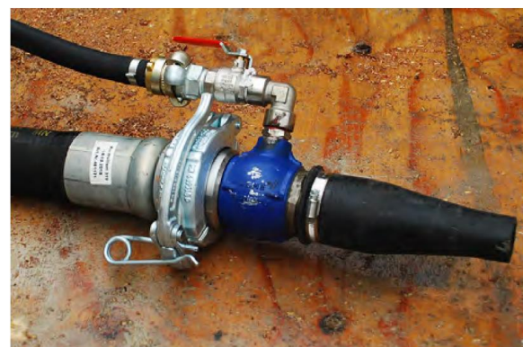
Bild 7: Dichtstromdüse Putzmeister Betonspritzgerät SK65 (© HM)
