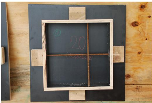
Bild 9: Vorbereitete Spritzkiste zur Untersuchung des Spritzschattens (© HM)
