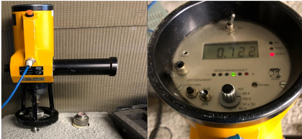
Bild 14: Haftzugerät Gesamtansicht sowie Detailansicht
