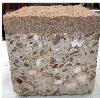
Bild 20: Verbundprobekörper aus Ortbeton und Spritzmörtel nach Temperaturbeaufschlagung
