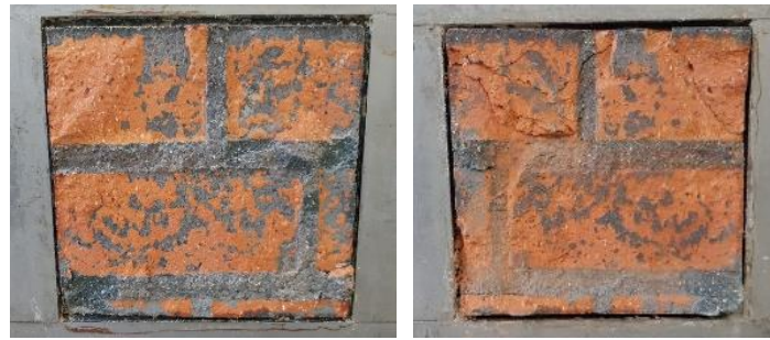
Bild 17: Links: Stahlformunterteil mit Mauerwerk, Rechts: Stahlformoberteil mit Instandsetzungssystem
