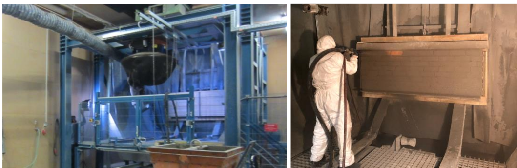
Bild 13: Spritzbetonversuchsstand der Ruhr-Universität Bochum; Auftrag Geopolymerspritzmörtel auf Mauerwerk
