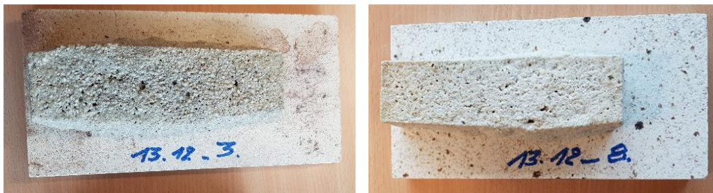
Bild 5: Probekörper der Rezepturen 3 und 8 nach Temperaturbeaufschlagung nach [10]
