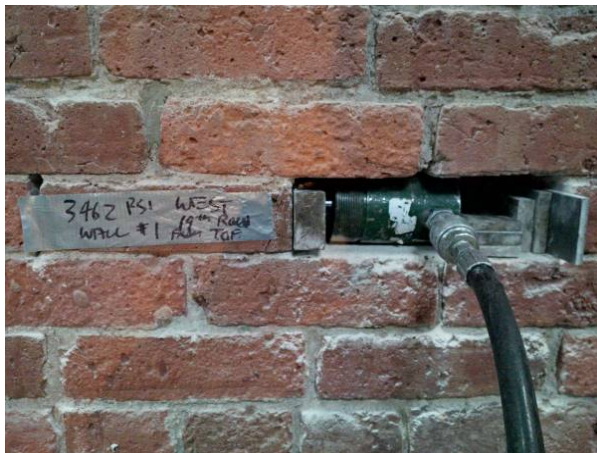
Bild 5: Bestimmung der Schubfestigkeit von Mauer Mörtel
