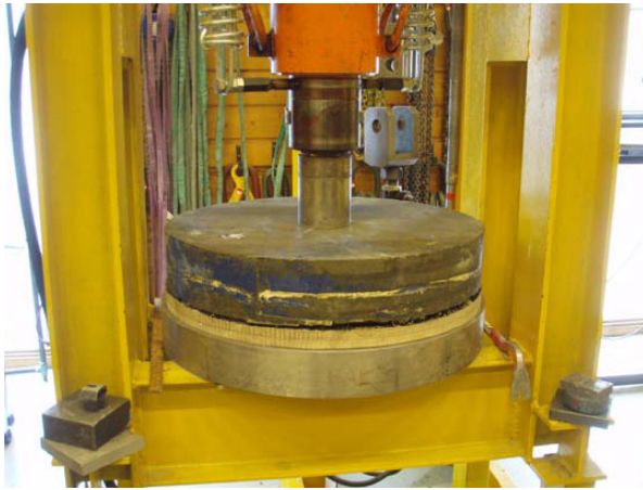
Bild 14: Prüfpresse für die Energieaufnahme an Rundplatten (Bild: BASF)
