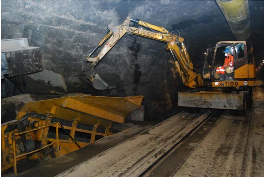
*Bild 10: Befüllen des Brechers untertage*
