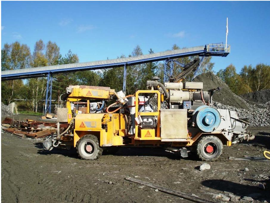
*Bild 11: Nassspritzgerät Aliva PM407 mit aufgebautem Kompressor*
