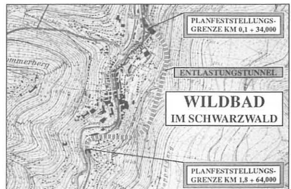
Bild 1: Trassenverlauf des Umfahrungstunnels Stadt Bad Wildbad
