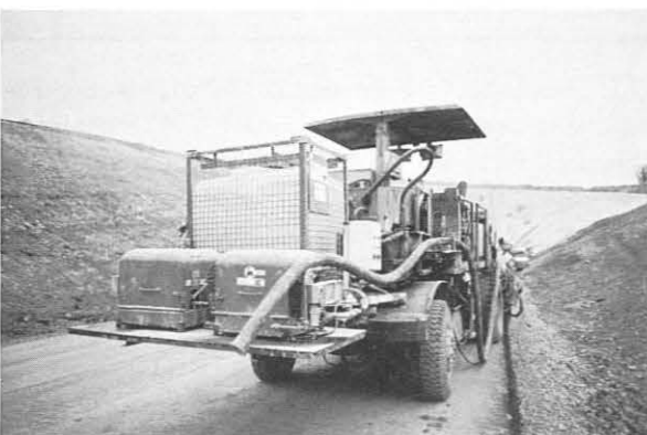
Abb. 2 Flüssig-BE-System, gesamt auf einem für Spritzbetonarbeiten umgebauten früheren Bohrwagen aufgebaut.
