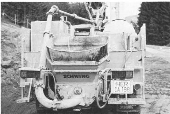
Abb. 6 Betonpumpe für Spritzbeton auf LKW-Fahrwerk
