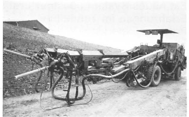
Abb. 3 Vorderansicht des Fahrzeugs mit Spritz-Manipulatoren, Düsen und Spritzrohren.
