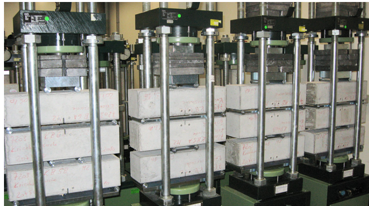
Bild 1 und 2: Prüfanordnung der Kriechversuche an Balken
